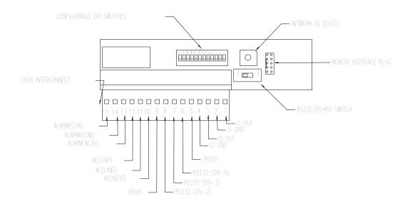
Power Entry: 85-250vac, 50/60 Hz. Use AC(GND), AC(LINE), AC(NEU)
